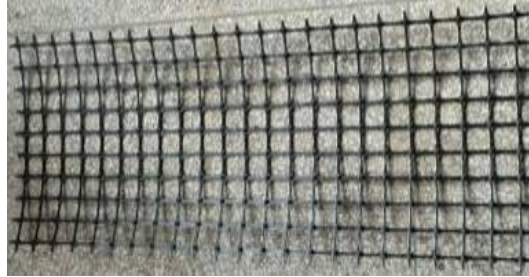
图 2 试验所采用的土工格栅示意图
