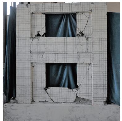
图 5 试件损伤模式图
